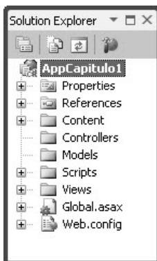
Figura 1.5 – Estrutura de arquivos e diretórios do website ASP.NET MVC.
